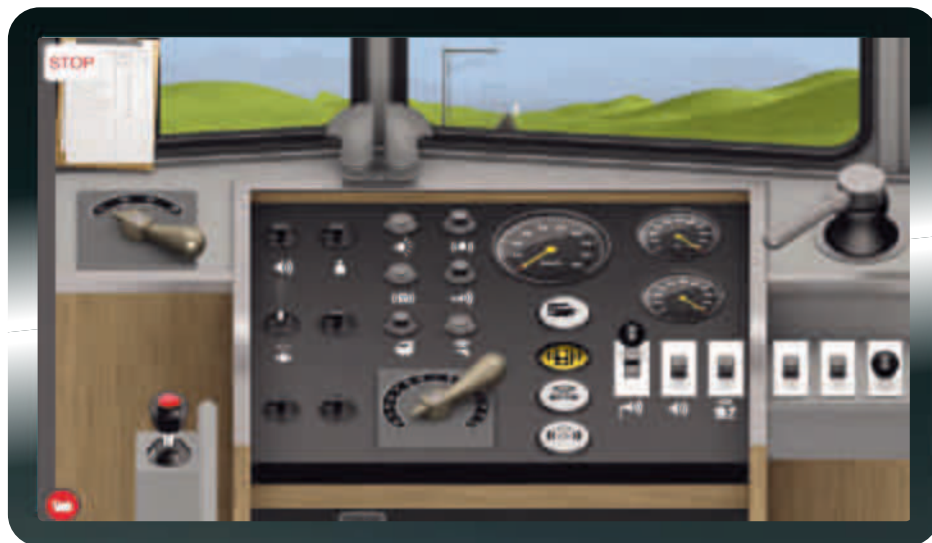
Wie beim Vorbild: Die Türen schalten wir mit dem zweiten Knopf unter dem Tacho, die Bahnhofsansage mit dem Hebel rechts daneben. Die Bremse rechts oben ist noch angezogen.
