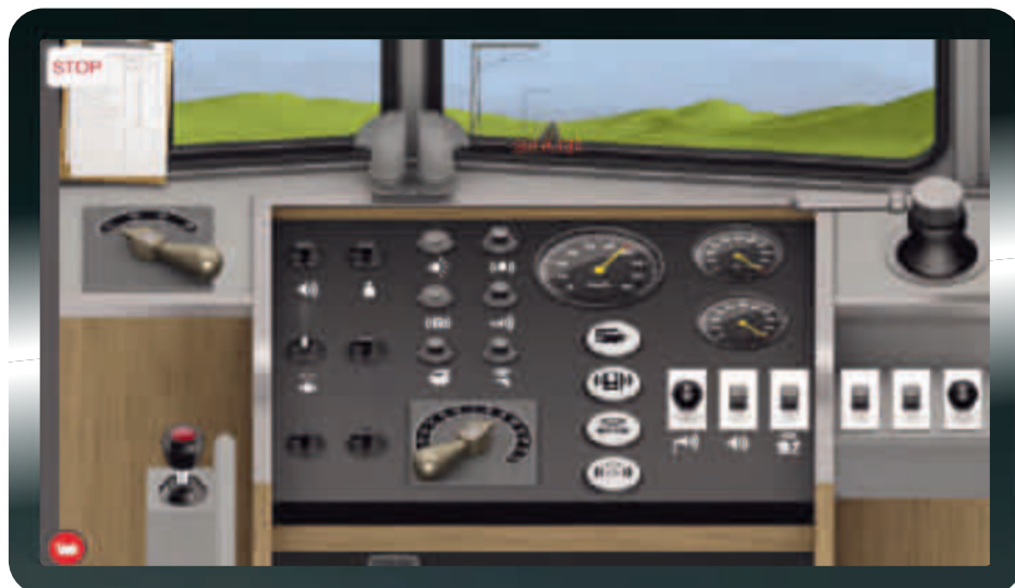
Während der Fahrt muss spätestens wenn die SiFa-Anzeige in der Frontscheibe erscheint, der leuchtenden SiFa-Knopf oder ein Drehregler gedrückt werden, sonst bleibt die Lok stehen.
