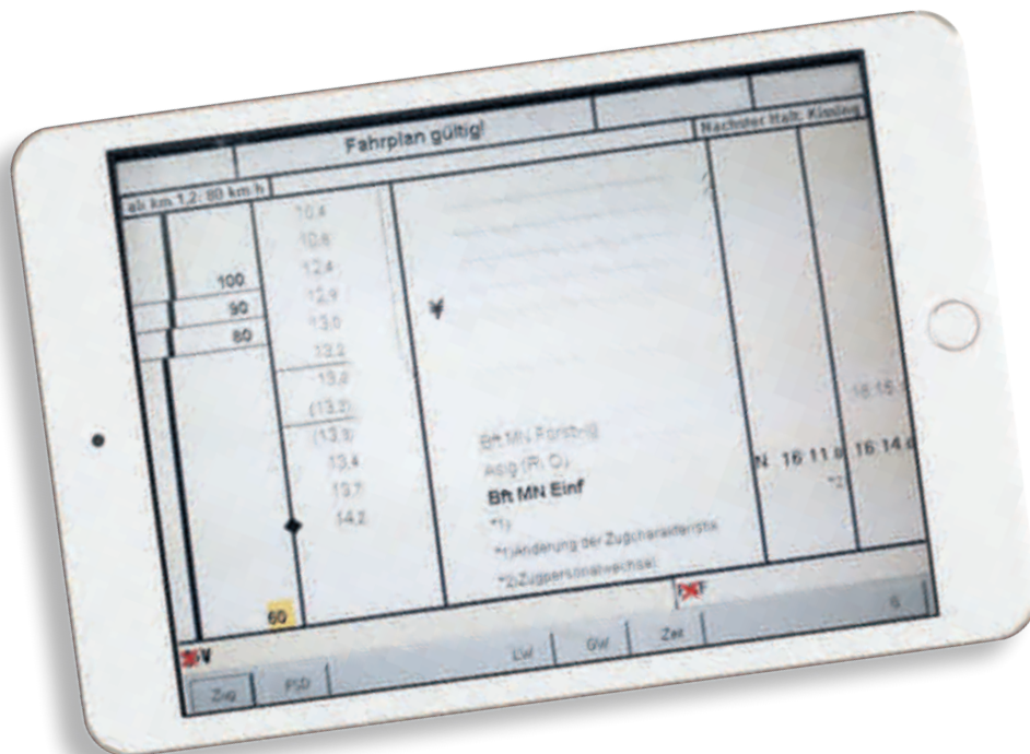
Der Buchfahrplan ist bei heutigen Fahrzeugen elektronisch und kann leicht aktualisiert werden.
