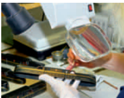
Farbgebung: Aus dem Gehäuse macht die Lackiererei mit Spritzpistole, Druckmaschine und manchmal auch mit dem Pinsel ein perfektes Modellkleid.
