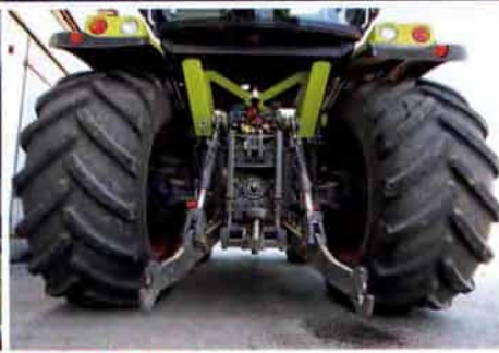
MUSKELPAKET: 12 Tonnen Hubkraft, bis zu vier Anbaugeräte und ISO-Anschluss.
