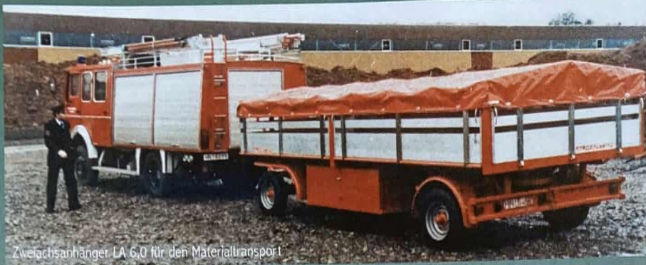
Zweifachsanhänger LA 6.0 für den Materialtransport
